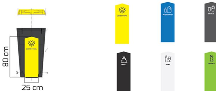
Cada contenedor para el Punto Limpio de tipo “Contenedores Clasificados” de 6 seis contenedores debe ser fabricado a partir de polietileno de alta densidad permitiendo una gran resistencia al golpe y a la rotura y deben tener ruedas para fácil desplazamiento.
