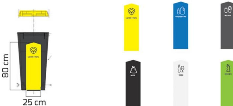
Cada contenedor para el Punto Limpio de tipo “Contenedores Clasificados” debe ser fabricado a partir de polietileno de alta densidad permitiendo una gran resistencia al golpe y a la rotura y deben tener ruedas para fácil desplazamiento.
