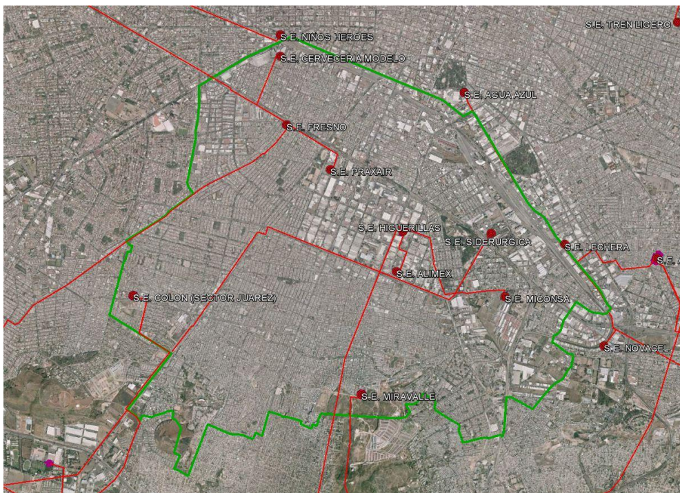
Ilustración 18. Localización de líneas de transmisión y subestaciones eléctricas de CFE. Fuente: Elaboración propia a partir de datos de CFE.
