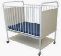
5. Cuna Bacinete tubular, tubo redondo de 1" cal. 18 con refuerzos inferiores en forma de "H", refuerzos superiores donde descansa el bacinete. Cuenta con dos posiciones y una inclinación máxima de 10°. Estructura: Terminado cromado. Rodajas: De 2" tipo bola de hule natural color negro con herraje cromado. Bacinete: De acrílico transparente reforzado de 3mm, Colchoncito: Hipo alérgico de poliuretano de hule espuma forrado de vinil impermeable y lavable con o sin motivos infantiles.
