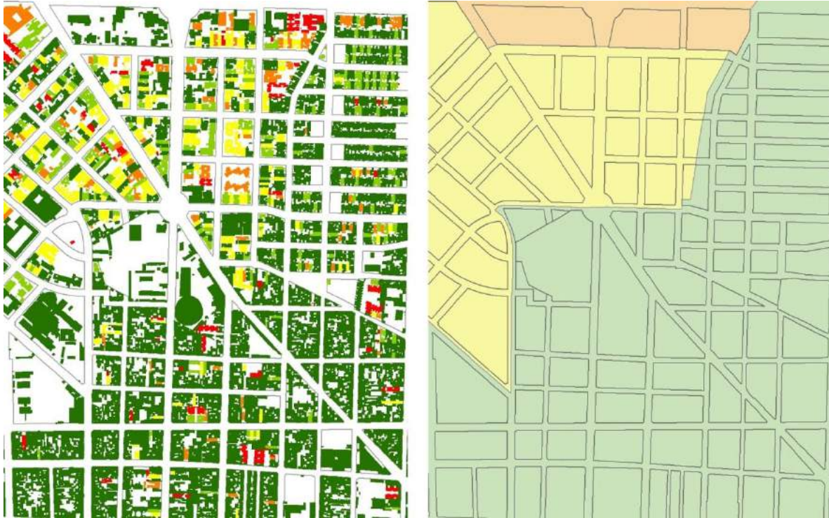
Imagen 7.1.1.3. Modelo de generalización de restricciones frontales de las edificaciones.
